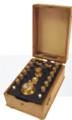
Tento kalibrační potenciometr z roku 1900 byl používán se standardní baterií a galvanometrem, jako je ten uvedený výše. Jeho cena: 195 franků!
